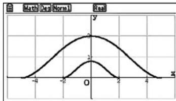
Mit dem GTR wird die Fläche unter der unteren Kurve berechnet: Es ergibt sich ein Flächeninhalt von ca. 1,71 m<sup>2</sup>.
