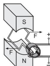
flossene rechteckige Spule erfährt senkrecht zu den Magnetfeldlinien zwei Lorentzkräfte  $\vec{F}$ , welche die Spule drehen. In dem Moment, in dem die Spulenfläche senkrecht von den Feldlinien durchsetzt wird, kehrt ein sogenannter Kommutator die Stromrichtung in der Spule um und bewirkt so zusammen mit ihrem Eigenschwung ein Weiterdrehen in der ursprünglichen Richtung.
